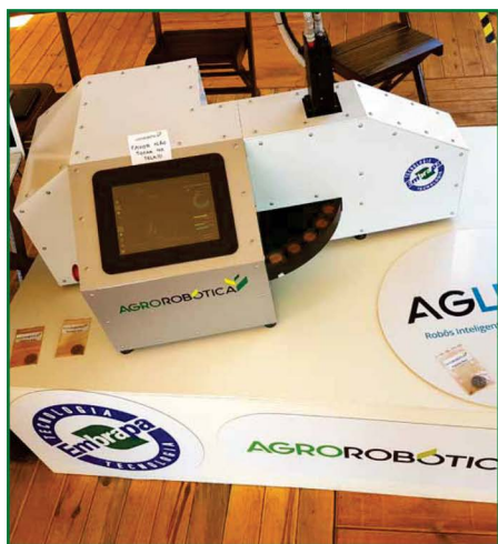
Figura 4 - Equipamento AgLIBS para determinação rápida da textura, pH e teor de carbono do solo.
