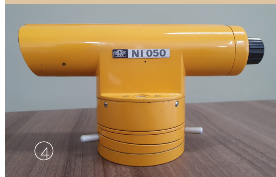
Nível Ótico Suíço, Marca Carl Zeiss, modelo NI 050
