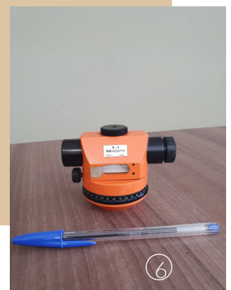
Nível óptico mecânico, marca Sion, modelo N-4 brasileiro
