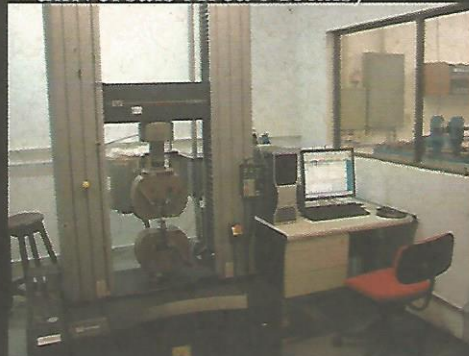
Instron (máquina de ensaios universais Área Metais)
