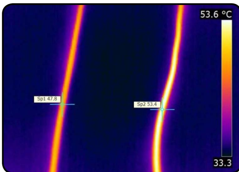
**Cabo de cobre 1,5 mm<sup>2</sup> (Normalizado)**
