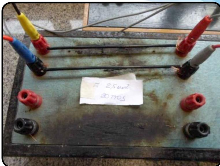
Imagem 18 - Circuito para análise da fadiga cabo 2,5 mm<sup>2</sup> "desbitolado"
