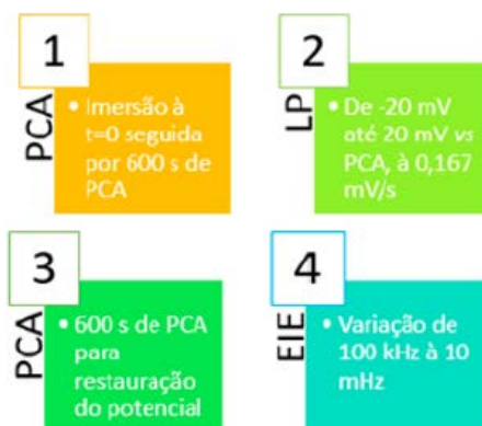
Figura 1. Fluxograma do protocolo utilizado no ensaio eletroquímico, Autores (2024).
